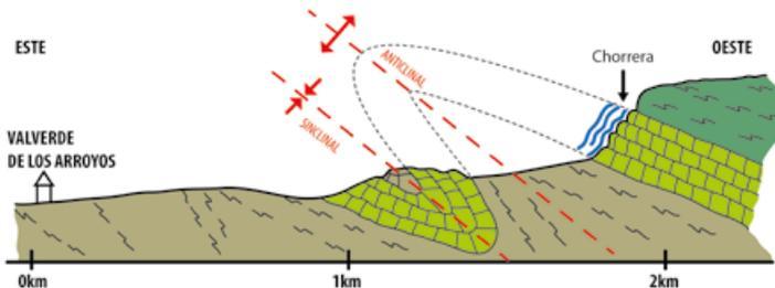
**Figura 7-3** Esquema geológico del pliegue que origina el salto de agua de la Chorrera de Despeñalagua. Se corresponde con la figura 7-2. Leyenda igual que la Fig.6-3 basado en IGME (2005).
