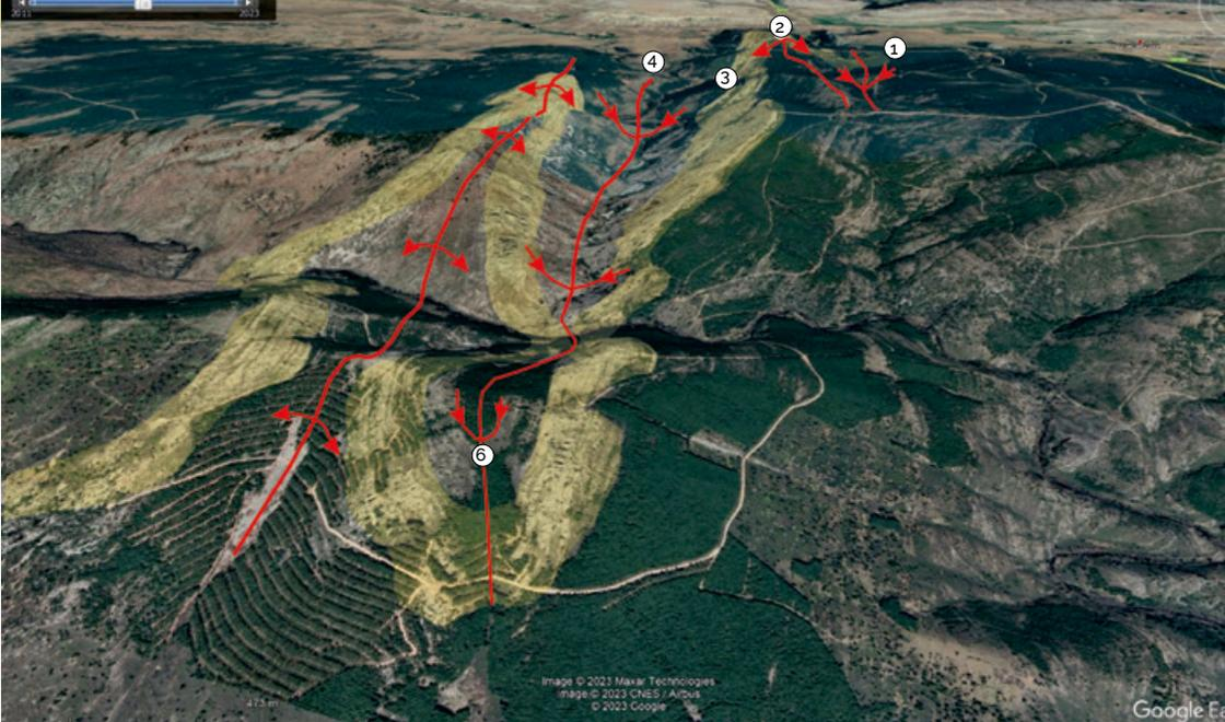
**Figura 6-2** Distribución tridimensional de la formación de cuarcitas (amarillo). En rojo se indican los ejes de los pliegues anticlinales (flechas hacia afuera) y sinclinales (flechas hacia dentro) de dirección norte-sur. Los números indican la posición de las correspondientes paradas, excepto la 6, que indica lo que se ve desde esta parada (el pliegue, correspondiente al de la Fig. 6-1). La perspectiva distorsiona ligeramente la geometría de algún rasgo. Imagen de fondo: Google Earth.
